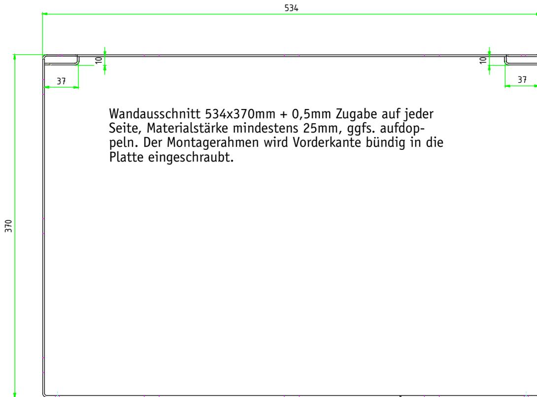
Wandausschnitt 534x370mm + 0,5mm Zugabe auf jeder Seite, Materialstärke mindestens 25mm, ggfs. aufdoppeln. Der Montagerahmen wird Vorderkante bündig in die Platte eingeschraubt.
